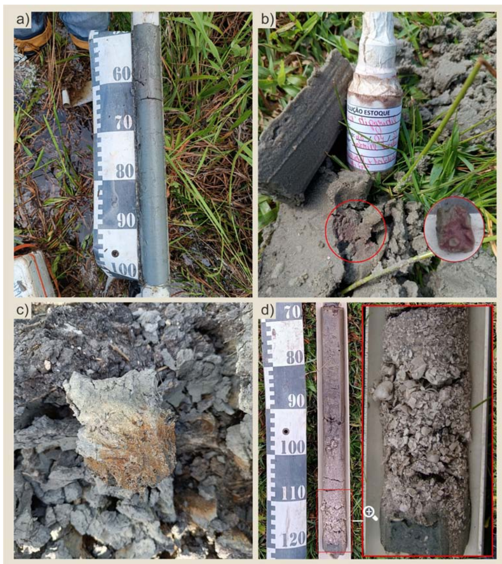
Figura 13. Feições morfológicas típicas: (a) matriz reduzida; (b) matriz reduzida com reação positiva (rosa/vermelha) ao indicador químico de \text{Fe}^{+2} - \alpha , \alpha' dipiridyl (bipiridina); (c) feições redoximórficas amarelas de jarosita em horizonte com material sulfídrico exposto à drenagem; (d) caracteres carbonático e hipocarbonático com a concentração de fragmentos de conchas. Fonte: Dos autores.
